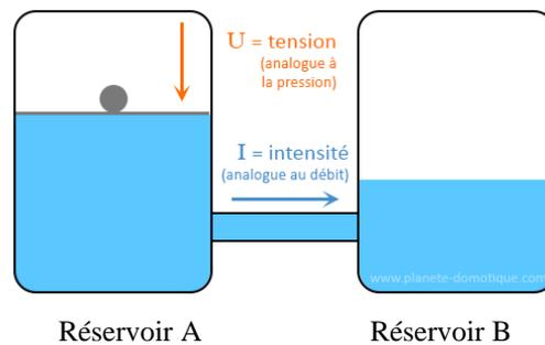
Fig.1.1. Analogie entre l'électricité et un montage hydraulique
